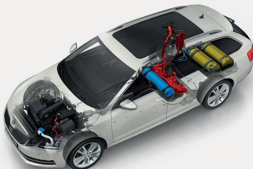
Moteur d'une Skoda Octavia G-TEC, avec les deux bonbonnes de gaz à l'arrière. © SKODA AUTO
